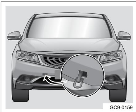
В случае поломки автомобиля можно произвести его буксировку с использованием передней или задней буксировочной проушины. Прουшина не может быть использована для буксировки других автомобилей. Также запрещено использование проушины для буксировки прицепа.
