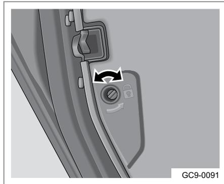
Задние двери автомобиля оснащены устройством защиты от открывания детьми. Устройство защиты от открывания двери детьми следует использовать в том случае, если на заднем сиденье находится ребенок. Замок устройства защиты от открывания двери детьми находится на наружном крае задней двери. Если вставить механический ключ в этот замок и повернуть против часовой стрелки, устройство перейдет в за-
