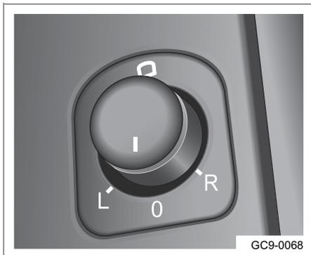
1. Переведите кнопка «СТАРТ/СТОП» в режим «ON». Поверните переключатель регулировки наружных зеркал в положение «L» (левое) или «R» (правое) для выбора зеркала на водительской или пассажирской двери соответственно.
