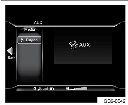
Подсоедините внешний аудиоплеер с разъемом AUX к мультимедийной системе автомобиля при помощи гнезда AUX 3,5 мм и воспроизводите музыку, записанную на внешнем аудиоплеере при помощи данной функции. Все управление будет выполняться только на внешнем устройстве.
