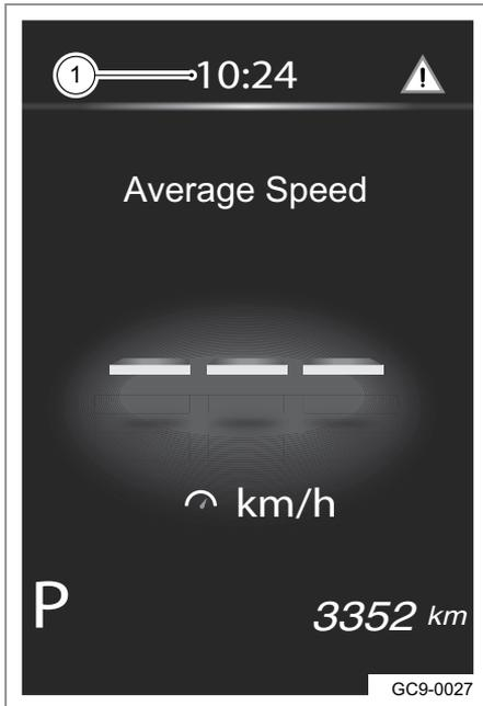
Часы (1) отображаются в верхней части дисплея комбинации приборов.
