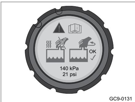
1. Медленно поворачивайте крышку против часовой стрелки. Если при этом слышен шипящий звук, не продолжайте открыва-
