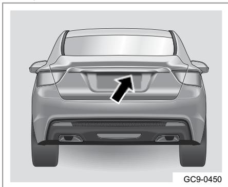
Если, имея при себе действующий пульт дистанционного управления, нажать кнопку открывания багажника, багажник будет отперт.
