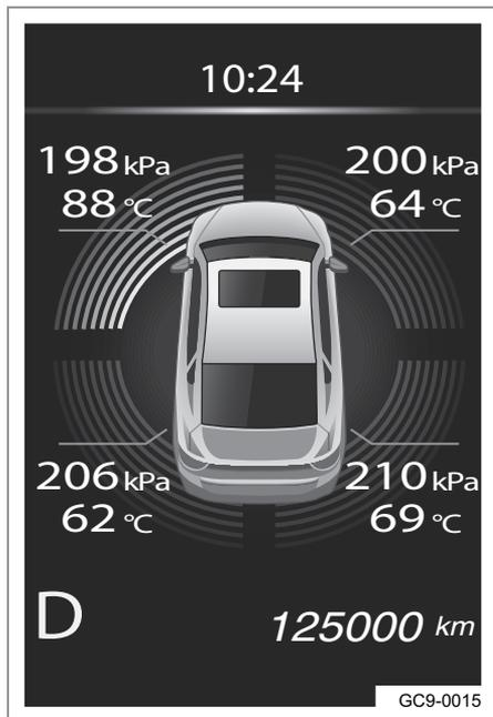
Значения давления и температуры воздуха в шинах отображается на дисплее в режиме реального времени.
