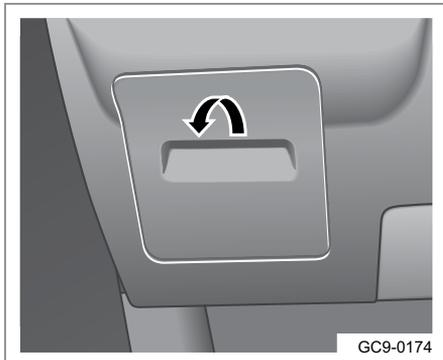
Центральный распределительный блок находится позади приборной панели с левой стороны. Откройте крышку и проверьте предохранитель.
