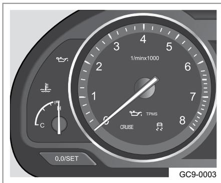
Тахометр показывает частоту вращения коленчатого вала двигателя в оборотах в минуту (об/мин). Предел показаний прибора составляет 8000 об/мин, красная зона шкалы начинается с 6000 об/мин.
