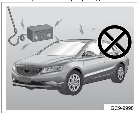
4. При подключении отдельной линии питания для дополнительного оборудования сильный нагрев в месте соединения проводов, вызванный большой разностью сопротивлений, может стать причиной возгорания электропроводки.
