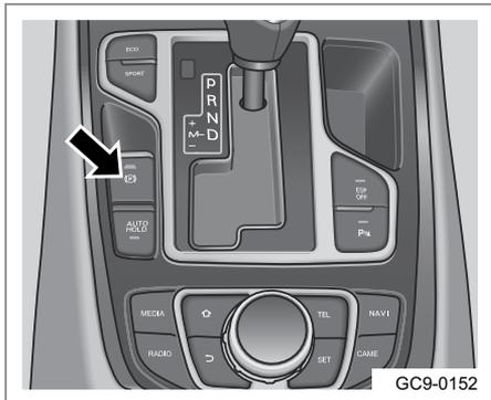
Кнопка электрического стояночного тормоза расположена слева от селектора АКПП.
