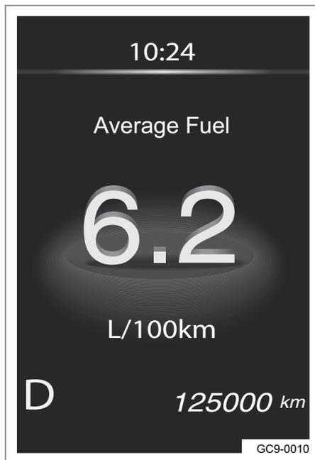
Отображается средний расход топлива с момента последнего сброса показаний (по умолчанию в л/100 км (L/100 km)) для помощи водителю в определении режима экономичного вождения с целью уменьшения расхода топлива. Показания обновляются раз в 10 секунд. Для измерения среднего расхода топлива в конкретный период вождения, предварительно сбросьте текущие показания, удерживая нажатой кнопку 0.0/SET. После сброса показаний на дисплее будет
