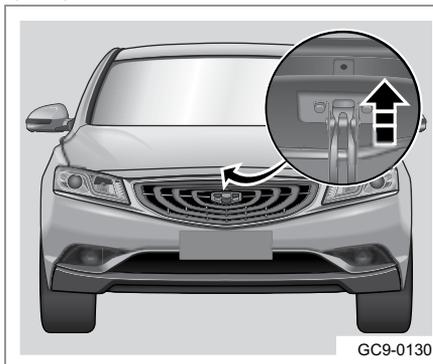
2. Чтобы освободить защелку, поднимите вверх предохранительный крючок, расположенный в просвете между решеткой радиатора и капотом.
