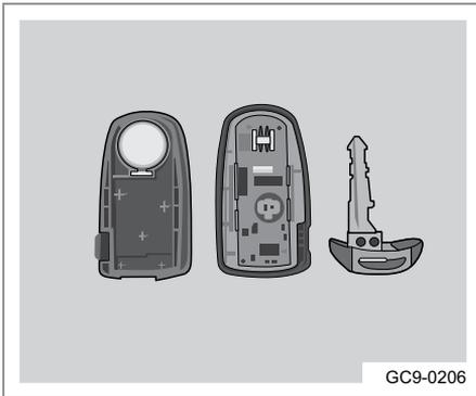
Открыв корпус пульта дистанционного управления, замените элемент питания на новый. Положительный полюс элемента питания должен быть направлен вниз. Модель элемента питания: CR2025 (3 В).
