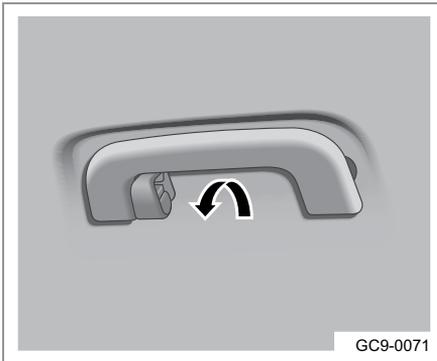
В салоне автомобиля предусмотрены потолочные поручни для пассажиров, расположенные со стороны переднего пассажирского сиденья и по обеим сторонам заднего сиденья. Потолочные поручни снабжены пружинными креплениями. При отпуске поручень автоматически возвращается в исходное положение.
