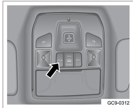
При включении наружного освещения загорятся лампы общей подсветки салона, расположенные на приборной панели, передних и задних дверях. Нажмите выключатель общей подсветки, чтобы включить лампы общей подсветки на потолке салона.
