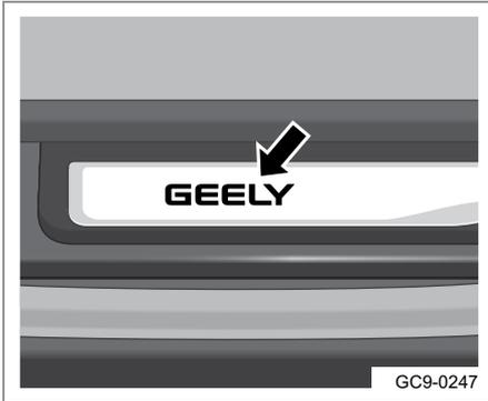
Дверной порог снабжен фоновой подсветкой, которая включается автоматически при открывании двери.
