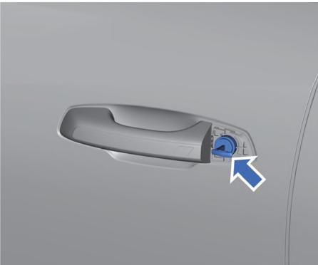
3. Вставьте механический ключ в скважину замка. Поверните ключ по часовой стрелке, чтобы запереть дверь; поверните его против часовой стрелки, чтобы отпереть дверь.
