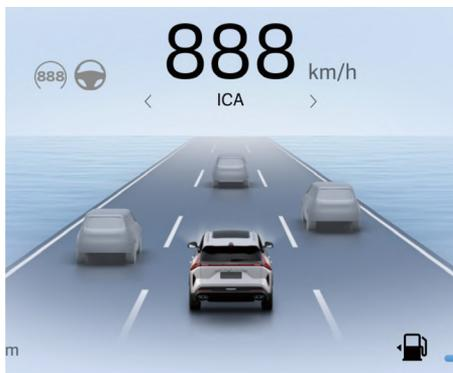
Систему интеллектуального круиз-контроля можно выбрать на дисплее комбинации приборов с помощью кнопки переключения меню функций на левой стороне рулевого колеса; после выбора система интеллектуального круиз-контроля перейдет в режим ожидания, а индикатор состояния системы интеллектуального круиз-контроля загорится серым цветом.
