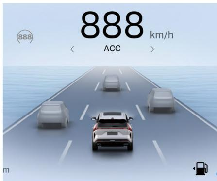
Систему АСС можно включить с помощью кнопки переключения функций, расположенной с левой стороны рулевого колеса. После включения система переходит в режим готовности к использованию, и индикатор состояния круиз-контроля загорается серым светом.
