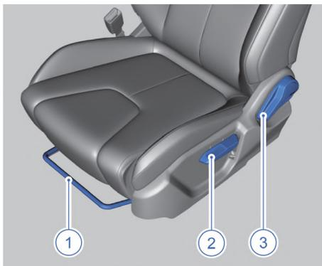
1. Рычаг регулировки продольного положения сиденья
