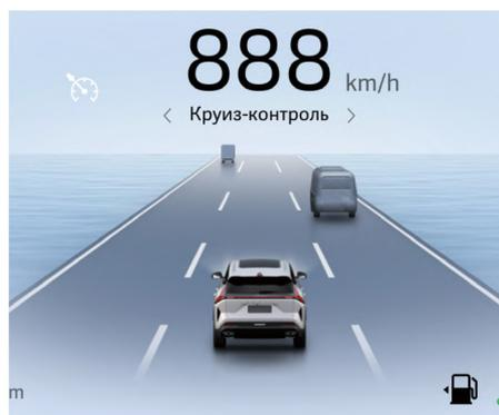
Система круиз-контроля включается соответствующей кнопкой на левой стороне рулевого колеса. После включения система переходит в режим готовности к использованию, и индикатор состояния круиз-контроля загорается белым светом.
