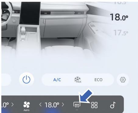
Нажмите выключатель обогрева заднего стекла и наружных зеркал заднего вида (☐) на панели управления климатической установкой. Загорится индикатор. Обогрев заднего стекла и наружных зеркал заднего вида будет включен одновременно. Он отключается автоматически через определенное время. Время работы зависит от температуры окружающего воздуха. Чем ниже температура окружающего воздуха, тем дольше работает обогрев.
