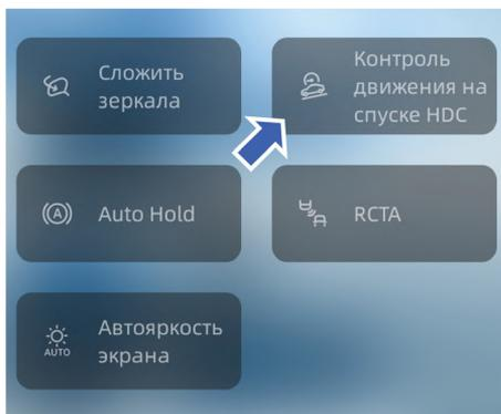
Проведите по экрану мультимедийной системы сверху вниз, чтобы раскрыть панель быстрых настроек. В этом интерфейсе включите или выключите функцию контроля движения под уклон.
