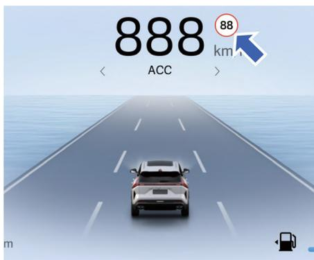
Система начинает отображать знак ограничения скорости, когда автомобиль проезжает мимо знака, и перестает его отображать спустя некоторое время.
