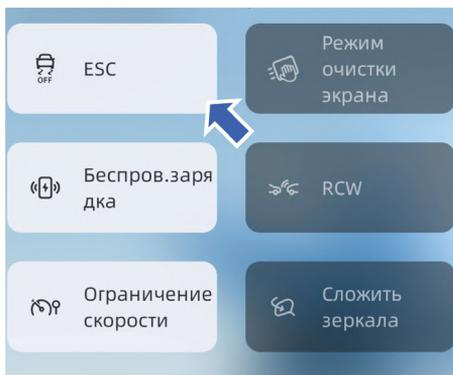
После запуска двигателя проведите по мультимедийному дисплею сверху вниз, чтобы раскрыть панель быстрых настроек, и включите или выключите электронную систему динамической стабилизации (ESC) в этом интерфейсе.
