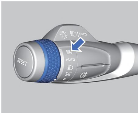
В темное время суток система интеллектуального управления дальним светом фар активируется автоматически после автоматического включения фар.
