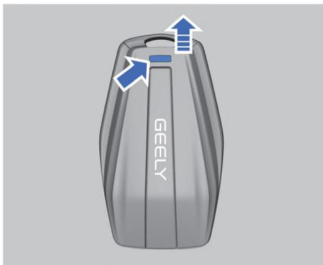
Нажмите кнопку на задней панели электронного ключа, чтобы извлечь механический ключ.
