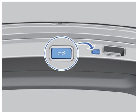
1. Во время открывания двери багажного отделения снаружи автомобиля нажмите кнопку закрывания двери багажного отделения, чтобы остановить движение двери.
