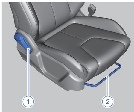
1. Рычаг регулировки наклона спинки сиденья
