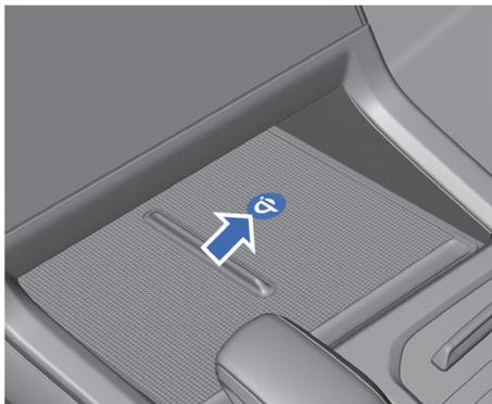
При использовании панели беспроводной зарядки следите, чтобы катушка мобильного телефона совпадала с катушкой в центре зарядной панели. Расположение катушки мобильного телефона зависит от модели телефона, поэтому может потребоваться скорректировать положение мобильного телефона на зарядной панели.
