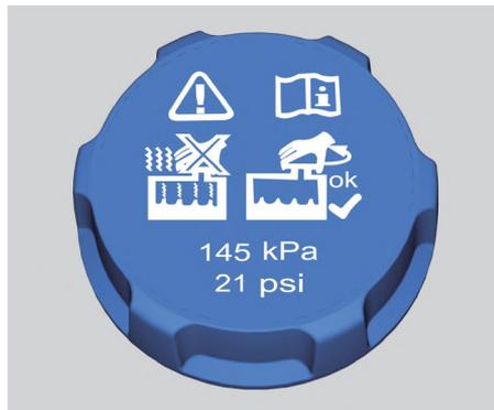
1. Медленно поверните крышку против часовой стрелки. Открывайте крышку только после того, как характерный шипящий звук прекратится. Шипящий звук указывает на то, что в бачке сохраняется давление.
