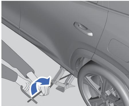
6. Вращая рукоятку домкрата по часовой стрелке, поднимите автомобиль на высоту, достаточную для снятия колеса.
