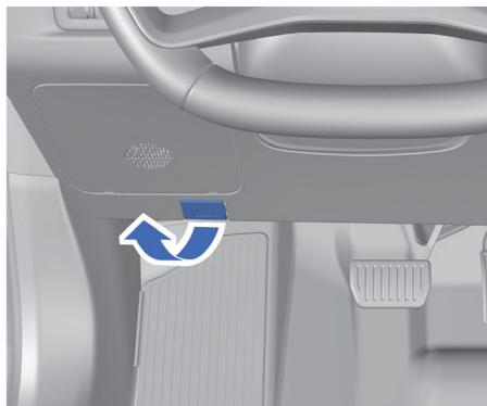
1. Потяните на себя рукоятку открывания замка капота, которая находится в левом нижнем углу приборной панели со стороны водителя.
