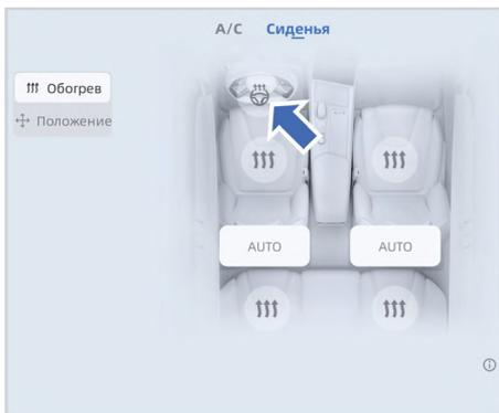
После запуска двигателя можно включить обогрев рулевого колеса соответствующим выключателем в интерфейсе мультимедийной системы. Обогрев отключается при достижении заданной температуры. Обогрев также можно отключить с помощью соответствующего выключателя.
