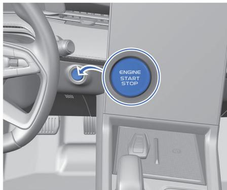
Автомобиль оснащен электронным пусковым переключателем кнопочного типа для бесключевого запуска двигателя. Для работы системы необходимо, чтобы действительный электронный ключ находился внутри автомобиля и определялся системой. Режимы питания, выбираемые с помощью пускового переключателя:
