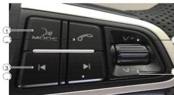
1. [MODE] Кнопка выбора рабочего режима: Короткое нажатие кнопки для отображения функциональных режимов для переключения в следующем порядке: радио  $\rightarrow$  музыка  $\rightarrow$  телефон  $\rightarrow$  настройки  $\rightarrow$  главная страница.; долгое нажатие кнопки в течение 2 секунд или больше для переключения на режим распознавания речи.
