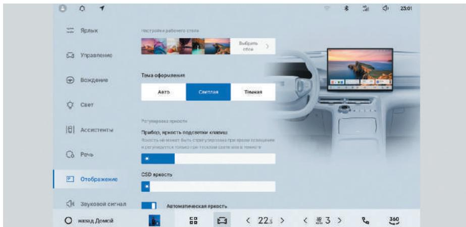
На дисплее мультимедийной системы последовательно выберите: «Настройки автомобиля → Отображение».
