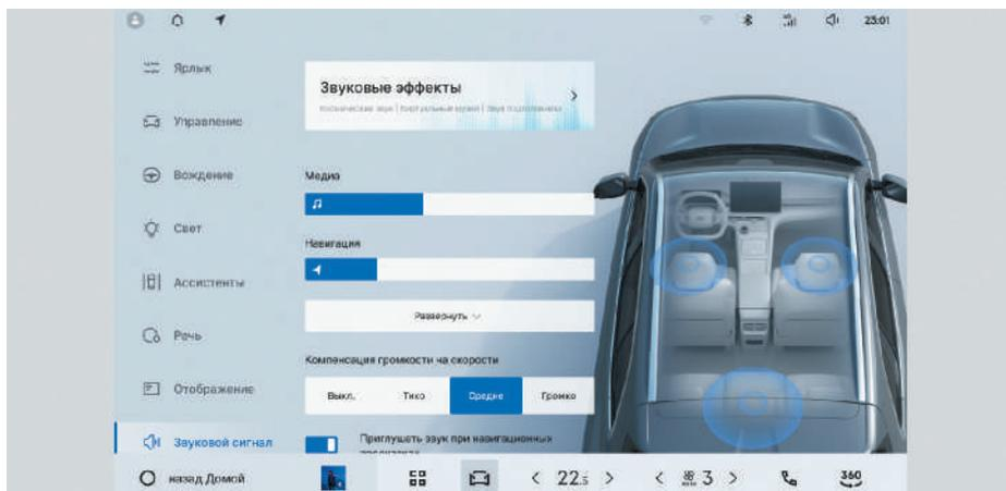
На дисплее мультимедийной системы последовательно выберите: «Настройки автомобиля → Звук».
