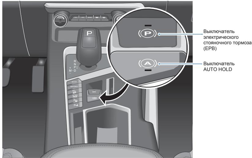
Выключатель электрического стояночного тормоза (EPB)
