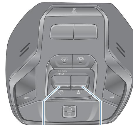
Переключатель люка и кнопка подъема/опускания люка
