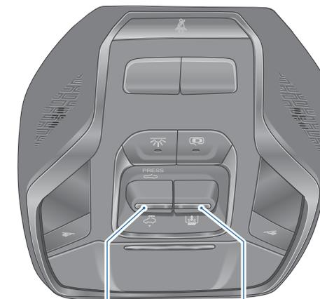
Переключатель люка и кнопка подъема/опускания люка
