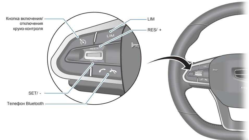
**Кнопка включения/отключения круиз-контроля**
