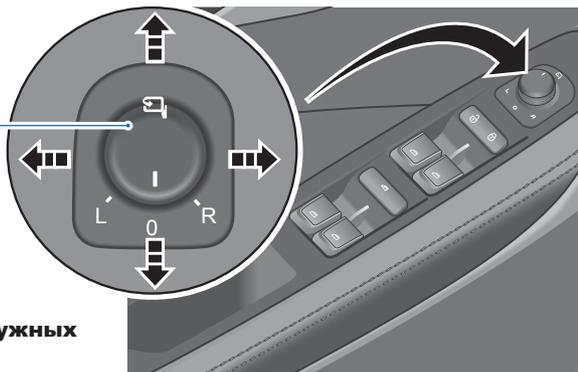
**Регулировка положения наружных зеркал заднего вида**
